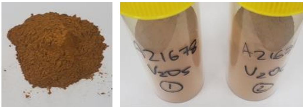
Kuva 19. Pilottilaitoksen vanadiinipentoksidia jauhemaisessa muodossa.
