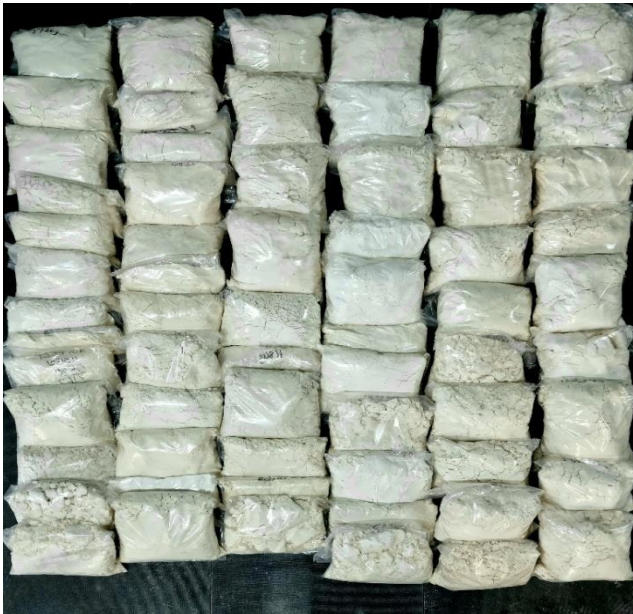
Kuva 18. Valikoituja AMV-tuotepusseja (kunkin paino 3-5 kg), jotka on valmistettu pilottilaitoksen käytön yhteydessä.
